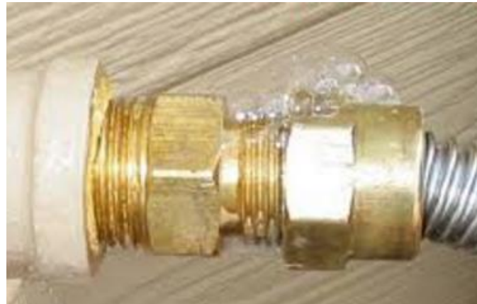
شکل ۵-۵: بررسی نشتی با کف و صابون
