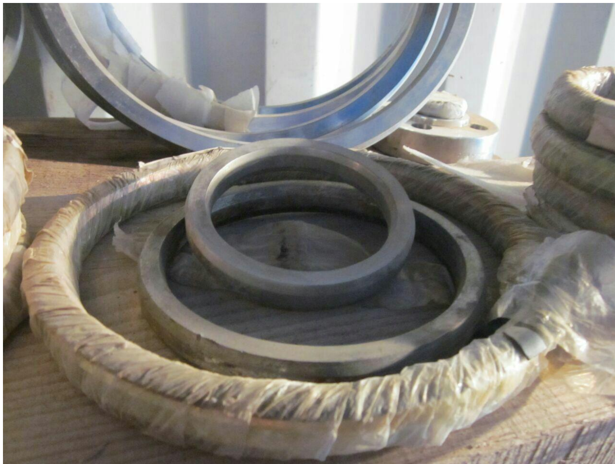
رینگ های مورد استفاده برای فلنج هایی با سطح RTJ
