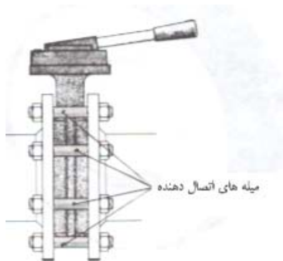
طرز نصب شیر پروانه‌ای
